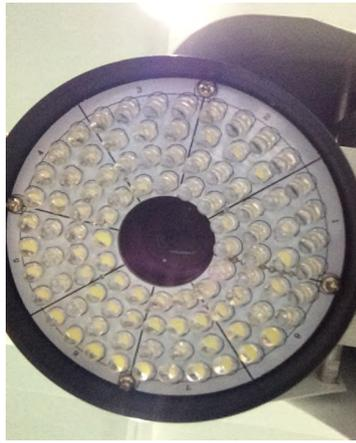
上光源采用 4 环 8 分区 LED 环形光源，可分区控制，寿命长，对各种产品表面光线照射非常清晰
