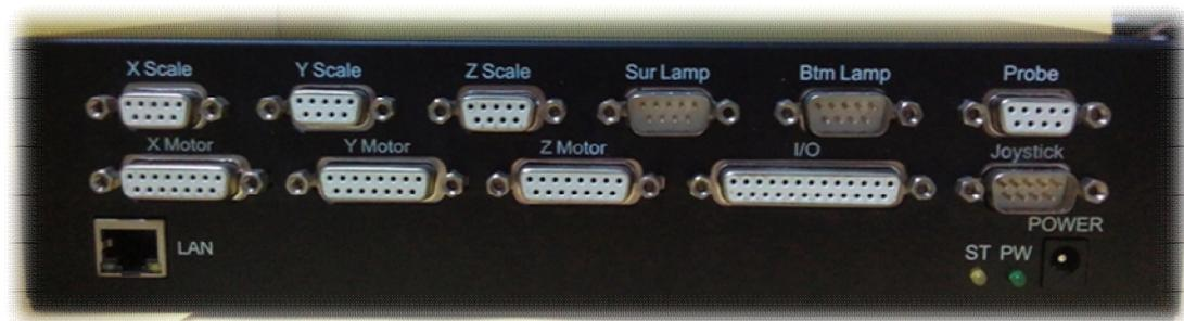
SBK4000 控制器是基于先进的 DSP 和 FPGA 技术，集四轴运动控制、电子尺计数、自动光源调节、探针处理、操纵杆等多功能于一体的全自动影像仪控制器。ACT400 采用以太网技术与电脑通信，具有无需驱动程序、兼容性好、传输速度快、传输稳定等优点
