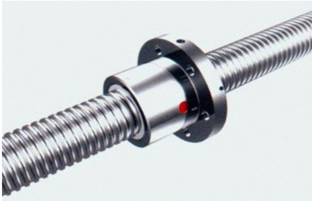
采用台湾“TBI” C0 级研磨滚珠丝杆，X、Y 轴采用导程 10mm 滚珠丝杆，可轻松实现 400mm 高速运动，Z 轴采用导程 2mm 滚珠丝杆，聚焦重复精度到到 0.003mm，研磨滚珠丝杆具有以下特点
